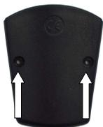
Togliere il coperchio del vano porta pile posto sul retro del trasmettitore (svitando le due viti di fissaggio), inserire una pila tipo 9V (nuova) nell'apposito vano ed agganciarla alla clip del trasmettitore, assicurarsi del perfetto contatto e richiudere il vano con il coperchio. Il trasmettitore segnala tramite un doppio beep l'avvenuto collegamento della batteria.
