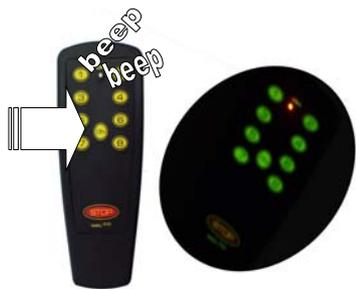
Il retroilluminatore consente una rapida ed agevole identificazione dei tasti anche in caso di scarsa luce: per illuminare la tastiera con il trasmettitore operativo premere e mantenere premuto il tasto on sino all'accensione (segnalata da due beep) del retroilluminatore. Con il trasmettitore spento è possibile prolungare la pressione del tasto on sino all'accensione del retroilluminatore.
