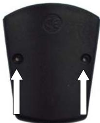
Togliere il coperchio del vano porta pile posto sul retro del trasmettitore (svitando le due viti di fissaggio), inserire una pila tipo 9V (nuova) nell'apposito vano ed agganciarla alla clip del trasmettitore, assicurandosi del perfetto contatto, richiudere il vano con il coperchio. Il trasmettitore è ora operativo: si accende il led ON.
