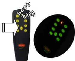
Il retroilluminatore consente una rapida ed agevole identificazione dei tasti anche in caso di scarsa luce: per illuminare la tastiera con il trasmettitore operativo premere e mantenere premuto il tasto on sino all'accensione (segnalata da due beep) del retroilluminatore. Con il trasmettitore spento è necessario accendere in primo luogo il trasmettitore, e successivamente premere il tasto ON fino all'accensione del retroilluminatore.
