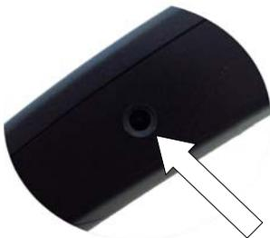
Die mit dem Übertragungsgerät gelieferte wiederaufladbare Batterie ist vom Typ *ohne Gedächtniseffekt* bzw. man kann sie jederzeit aufladen. Zum Aufladen ist es nötig, den entsprechenden Steckerstift in den Sitz auf der rechten Seite des Übertragungsgeräts zu stecken. Das Aufladen kann sowohl mit ein-, als auch mit ausgeschaltetem Übertragungsgerät erfolgen.
