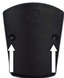
Den Deckel vom Batteriefach auf der Rückseite des Übertragungsgeräts entfernen (indem die zwei Befestigungsschrauben losgeschraubt werden), eine 9V-Batterie (neu) in das entsprechende Fach legen und in den Clip des Übertragungsgeräts einhaken, sich des perfekten Kontakts versichern und das Fach wieder mit dem Deckel schließen. Das Übertragungsgerät ist jetzt betriebsbereit: Die Leuchtdiode ON erlöscht.
