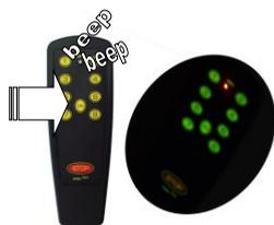
Il retroilluminatore consente una rapida ed agevole identificazione dei tasti anche in caso di scarsa luce: per illuminare la tastiera con il trasmettitore operativo premere e mantenere premuto il tasto on sino all'accensione (segnalata da due beep) del retroilluminatore. Con il trasmettitore spento è necessario prima accendere il trasmettitore, e successivamente premere il tasto ON fino
