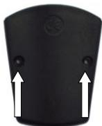
Togliere il coperchio del vano porta pile posto sul retro del trasmettitore (svitando le due viti di fissaggio), inserire una pila tipo 9V (nuova) nell'apposito vano ed agganciarla alla clip del trasmettitore, assicurandosi del perfetto contatto, richiudere il vano con il coperchio. Il trasmettitore segnala con un doppio beep, l'avvenuto collegamento della batteria.
