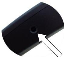
La batteria ricaricabile fornita con il trasmettitore (solo quando predisposto alla ricarica) è di tipo senza effetto memoria ovvero si può ricaricare in qualsiasi momento. Per procedere con la ricarica è necessario innestare l'apposito spinotto nella sede prevista sul fianco destro del trasmettitore. E' possibile effettuare la ricarica indipendentemente con il trasmettitore acceso o spento.
