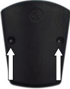
Otez le couvercle du logement des piles situés à l'arrière de l'émetteur (en dévissant les deux vis de fixation), introduisez une pile de 9V (neuve) dans le logement et accrochez-la à l'émetteur; vérifiez si le contact est correct et refermez le couvercle. Un double bip signale que l'émetteur est maintenant opérationnel.
