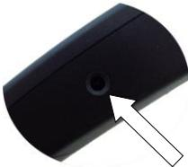
La batterie rechargeable fournie avec l'émetteur (seulement si l'émetteur est predisposé à la recharge) est du type *sans effet de mémoire* c'est-à-dire qu'elle peut se recharger à tout moment. Pour effectuer la recharge vous devez brancher la fiche dans le jack prévu sur le côté droit de l'émetteur. Vous pouvez effectuer la recharge avec l'émetteur allumé ou éteint.
