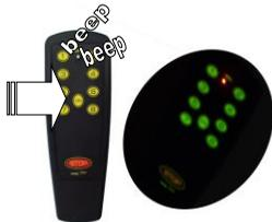
Le rétroéclairage permet de reconnaître les touches facilement et rapidement même en conditions d'éclairage insuffisant : pour éclairer le clavier lorsque l'émetteur est en marche, appuyez sans lâcher sur la touche ON jusqu'à ce que le rétroéclairage s'éclaire (signalé par 2 bips). Avec l'émetteur éteint, il faut tout d'abord l'allumer, et puis appuyer sur la touche ON jusqu'à ce que le rétroéclairage
