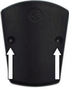
Otez le couvercle du logement des piles situés à l'arrière de l'émetteur (en dévissant les deux vis de fixation), introduisez une pile de 9V (neuve) dans le logement et accrochez-la à l'émetteur; vérifiez si le contact est correct et refermez le couvercle. Allumez l'émetteur pour le rendre opérationnel.
