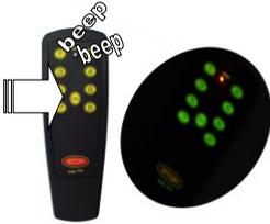
Die Beleuchtung von hinten ermöglicht eine schnelle und bequeme Identifizierung der Tasten, auch bei wenig Licht: Zur Beleuchtung des Tastfelds mit betriebsbereitem Übertragungsgerät, die Taste ON bis zum Angehen (durch zwei Pieptöne angezeigt) der Beleuchtung von hinten drücken und gedrückt halten. Mit abgeschaltetem Übertragungsgerät ist es möglich, das Drücken der Taste ON zu verlängern, bis die Beleuchtung von hinten angeht.
